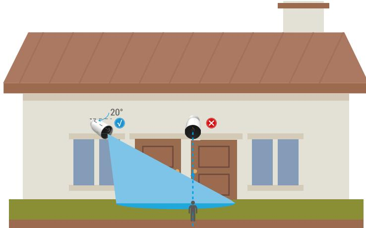
**i** Do bị giới hạn bởi công nghệ phát hiện PIR, camera có thể không phát hiện chuyển động khi nhiệt độ môi trường gần với nhiệt độ cơ thể người hoặc ai đó tiếp cận cảm biến PIR theo chiều dọc.
